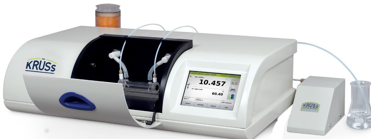
Halbautomatische Probenezufuhr mit P8000-TF und Schlauchpumpe DS7070
