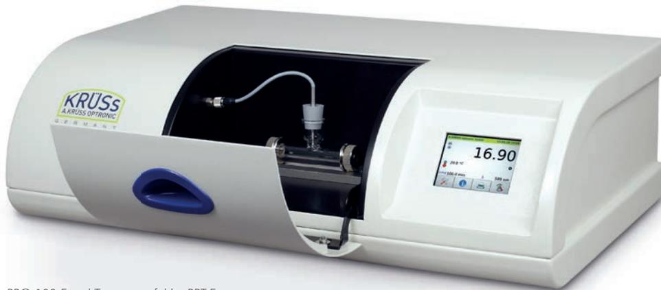
P3000 mit Messröhre PRG-100-E und Temperaturfühler PRT-E
